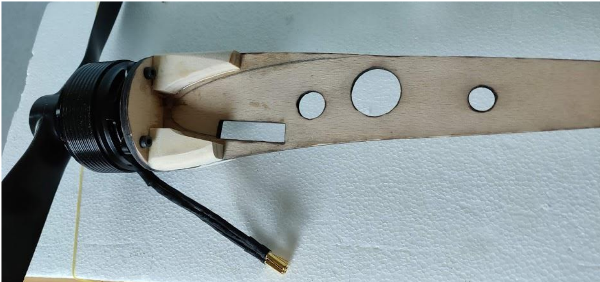
Les nacelles collées après finition du tronçon central
