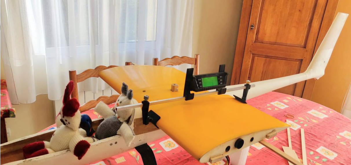
Les nacelles collées après finition du tronçon central
