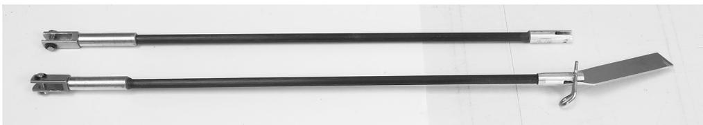
4 - Fabrication des haubans en Tube carbone (utilisé pour la construction des cerf-volants vendus dans les magasins de sport). Préparation des chapes de fixation qui seront posées définitivement au pré-montage. Des épingles type fixation de carrosseries voitures RC sont à prévoir dans leur plus petite dimension.
