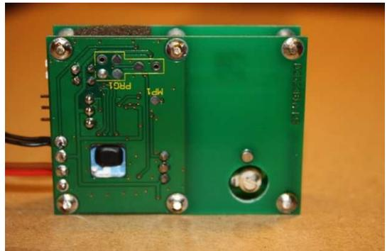
3. Ensuite on soude la platine HF. La notice recommande de souder sur l'arrière la quatrième patte, afin de la rendre plus solidaire de la platine principale (ce que j'ai fait). Il n'est pas possible de se tromper sur le positionnement de cette platine. Il faudra la positionner à 5mm de distance de la platine principale, comme indiqué sur ce schéma.
